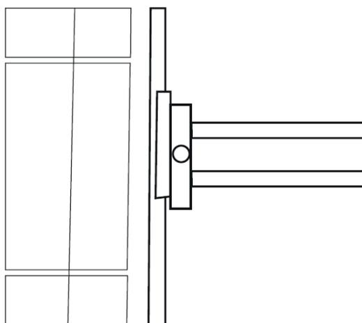
EN CAS D'INSTALLATION DIRECTE À TRAVERS LES ORIFICES SUR LES CADRES DES MODULES PHOTOVOLTAÏQUES, UTILISEZ CELLES SURLIGNÉES CI-DESSOUS EN NOIR AFIN D'ASSURER UNE MEILLEURE TENUE DES MODULES.
